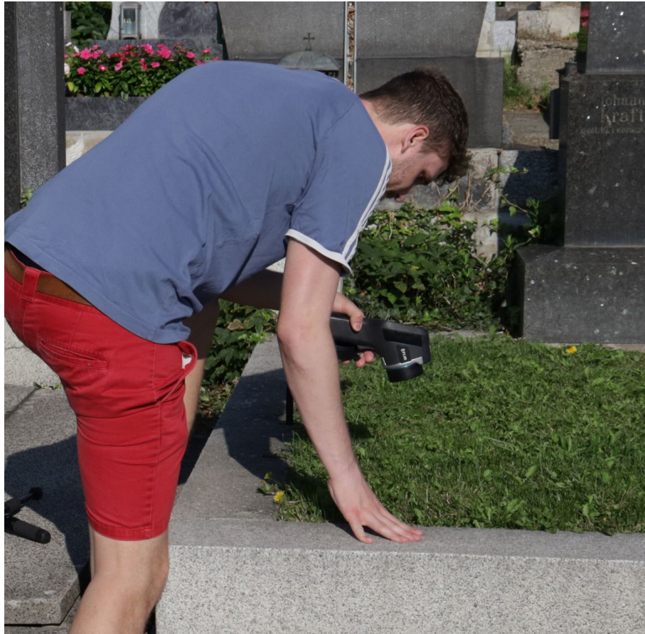
Abbildung 10: Messung der Oberflächentemperatur mittels Infrarotkamera
