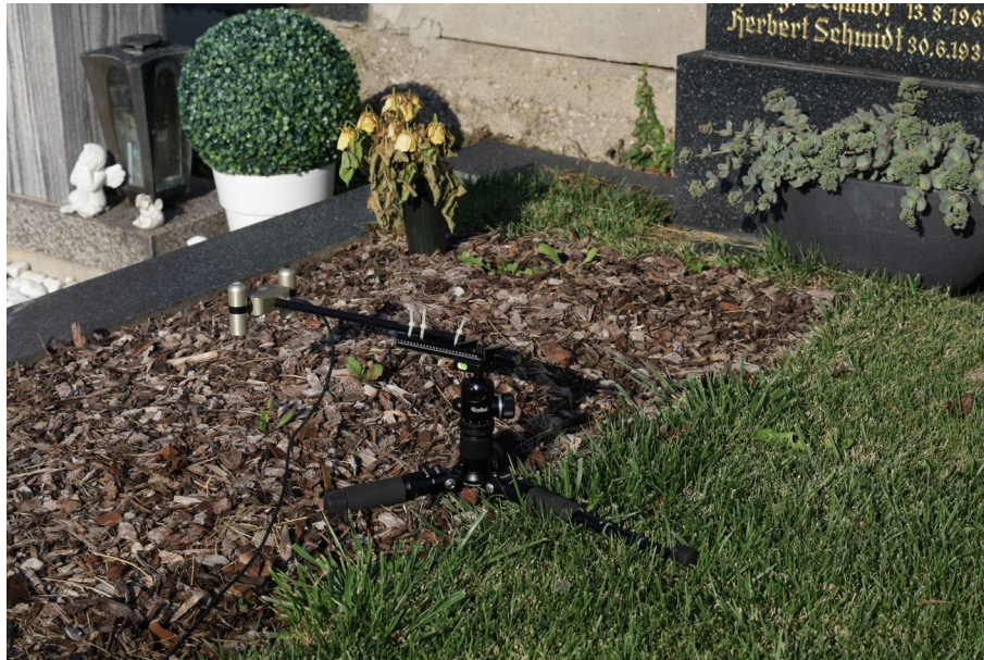
Abbildung 3: Albedomesssystem im Einsatz auf einer Graboberfläche mit Rindenmulch.
